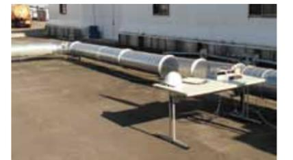
軽量物主体の空気輸送実験を行い、輸送ダクトの圧力変動を0.25秒単位で計測して解析を行いました。
