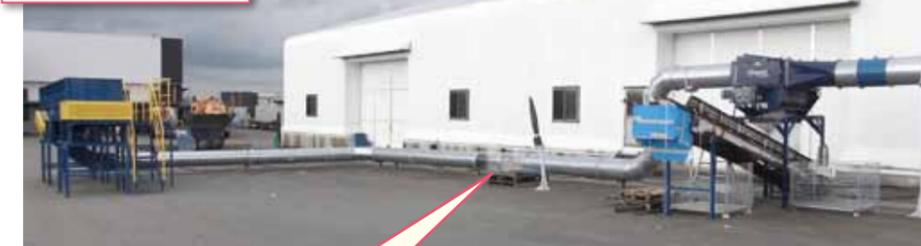
空気輸送実験装置は、定量供給コンベヤ、ロータリーセパレーター、ファンとダクト類で構成され、研究用にオリフィス、静圧及び差圧測定機が配置されています。輸送用のダクトは、350mm、500mmの直線ラインと90°バンド、45°バンド等を組み替えて実験を行いました。
