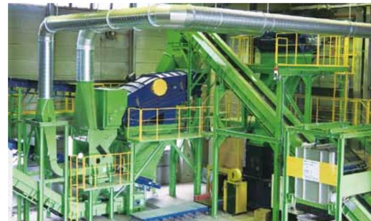
破碎後の材料は選別ラインへと運ばれ、篩機、風力選別機、磁選機、手選別の工程を経て高精度に選別されます。
